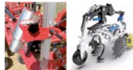
Slika 7. Kultivator za međurednu obradu a) sa IC kamerom, b) promena dubine i širine zaštitne zone
