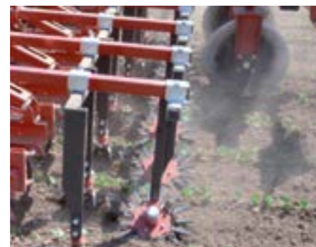
Slika 6. Kultivator za međurednu kultivaciju sa upravljačkim diskovima i GPS
