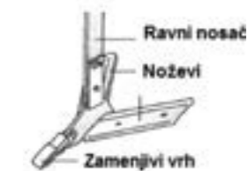
Slika 3. Kultivator sa dizajnom za zaštitu zemljišta, za veće količine biljnih ostataka 30-50%
