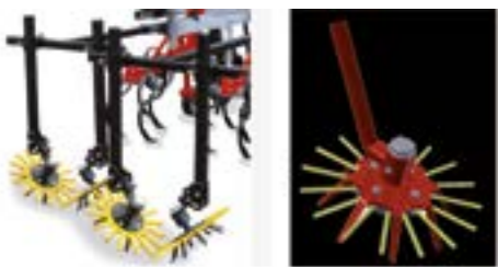
Sl. 5. Kultivator sa prstastim kotrljajućim plevilicama
