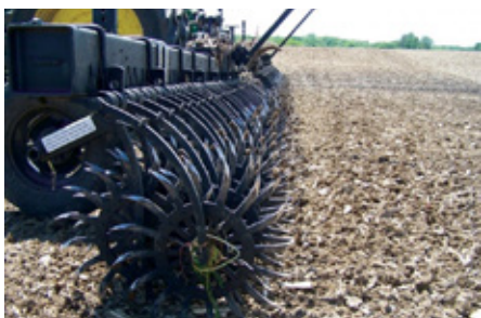
Slika 1. Standardna zvezdasta drljača za konvencionalnu obradu (Standard Rotary Hoe)
