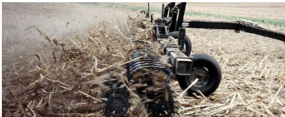
Slika 2. Zvezdasta drljača za povećane količine biljnih ostataka (Min-Till Rotary Hoe)
