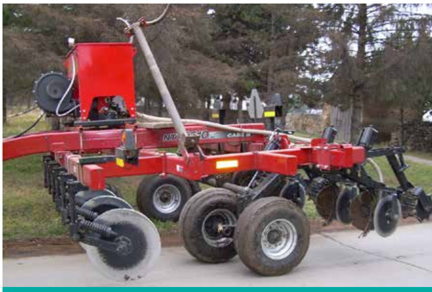
Slika 1: Mašina za obradu zemljišta StripTill sa unošenjem min. đubriva (Garalejić, Kovačica 2007.)
