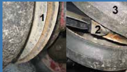
■ Sl.8. Dvostruki disk otvarač setvene brazdice (1) smaknuti samočisteći diskovi, (2) dodatni deo za oblikovanje dna, (3) točkovi za određivanje dubine brazdice
