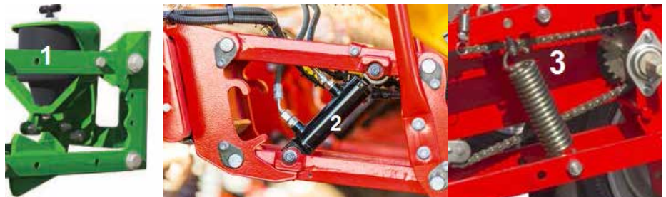
■ Sl.9. Elementi za postizanje i održavanje dubine rada, 1 pneumatski jastuk, 2 hidraulični sistem, 3 opruga
