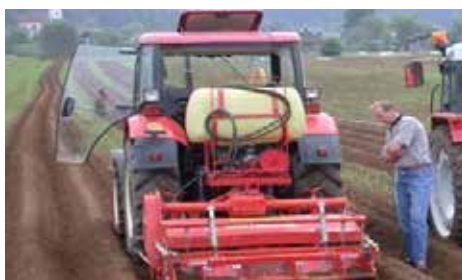
■ Slika 5,6,7. mehanizacija za aplikaciju insekticida u krompiru prilikom sadnje ili zagrtanja
