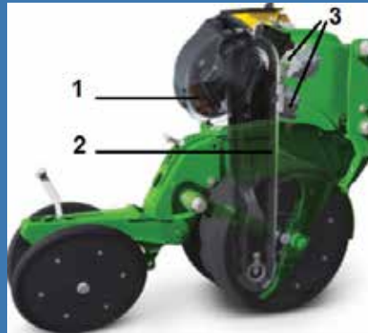
■ Sl.6. Setvena sekcija sejalice za preciznu setvu pri povećanim brzinama, sa setvnim aparatom sistema „BrushBelt™“, izuzimanje semena iz rezervoara setvenom pločom (1) transport semena do setvene brazdice kaišem sa četkom (2), seme se sa setvene ploče pomoću rotirajućeg skidača prebacuje na kaiš sa četkom pa nema slobodnog kretanja semena. Pogon ploče i kaiša je od dva elektromotora (3).
