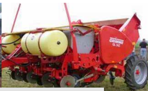
■ Slika 5,6,7. mehanizacija za aplikaciju insekticida u krompiru prilikom sadnje ili zagrtanja
