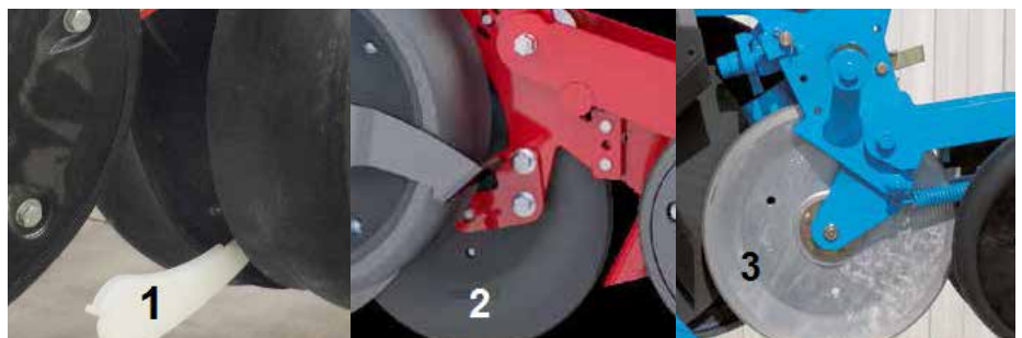
■ Sl.10. Elementi za utiskivanje semena u brazdicu, (1) plastični klizač, (2) gumeni točak, (3) metalni točak
