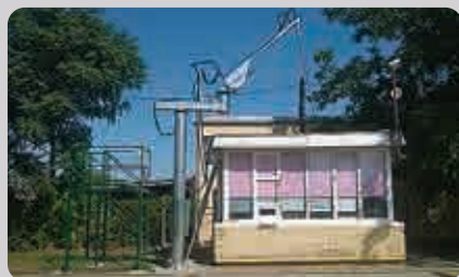
Automatske sonde postavljene za brži prijem robe i dobijanje kvalitetnijih uzoraka
