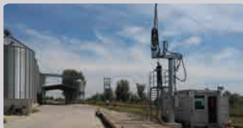
Automatske sonde postavljene za brži prijem robe i dobijanje kvalitetnijih uzoraka
