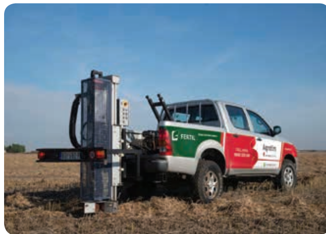
Slika 2. Vozilo sa automatskom opremom za uzorkovanje zemljišta
